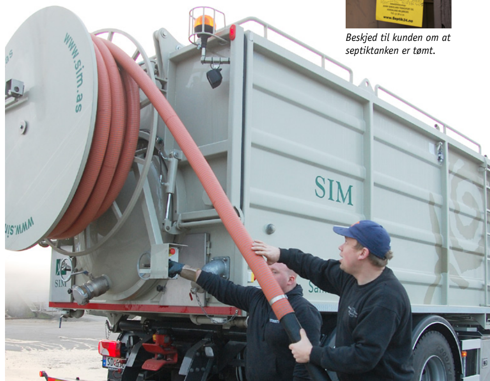
Avvatningsoperatørene Åge Raunholm (t.h) og Odd Gunnar Hustveit i ferd med å gjera klart for slamtømming. Renovatøren har rett til å plassera naudsynt utstyr på eigdommen, men pliktar å utføra tømninga med minst moegeleg støy og søl og å fjerna evt. søl.
